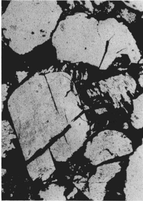
Abb. 13. Dünnschliff. Gibt einen Ausschnitt aus Abb. 12 wieder. Sie zeigt die Sprengung einzelner Mineralkörner durch das Erz und die teilweise Verdrängung des Feldspats durch den Pyrit (Vergrößerung 103fach).
